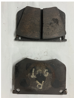
写真3 ブレーキパッド損傷
