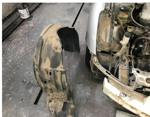
写真9 砂泥堆積状況
