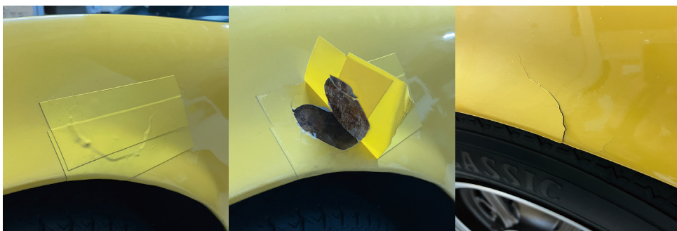
写真5 塗装剥がれ、浮き、割れ
