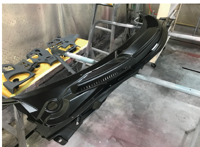
写真35 塗装補修1回目
