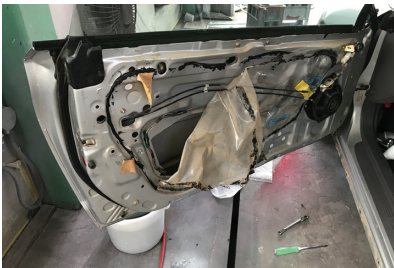
写真19 ドアトリムを外した状態
