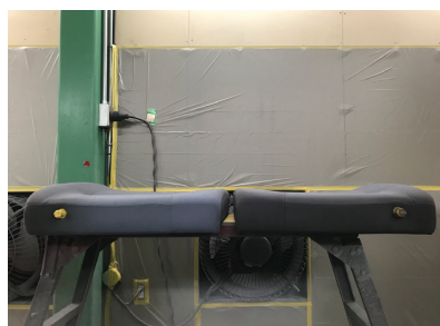
写真47 塗装比較(右:塗装後)
