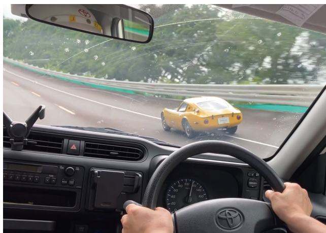
写真16 東富士テストコースでの走行確認(サポートカーとの並走による速度確認を実施)
