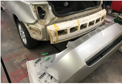
写真10 リヤバンパー取外し状態
