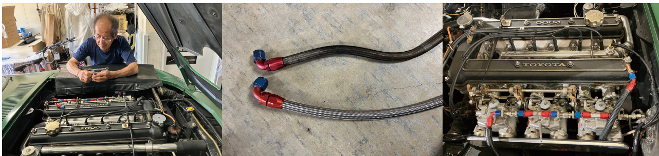
写真7 エンジンルーム内 水、オイル、燃料配管類交換
