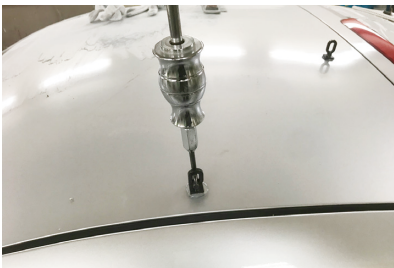
写真22 天井凹み部補修
