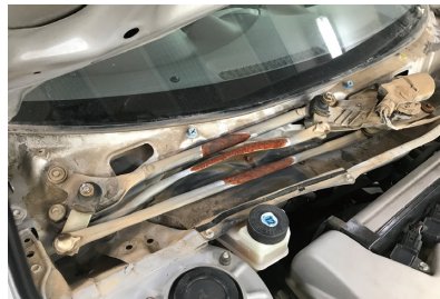
写真17 パネル取外し
