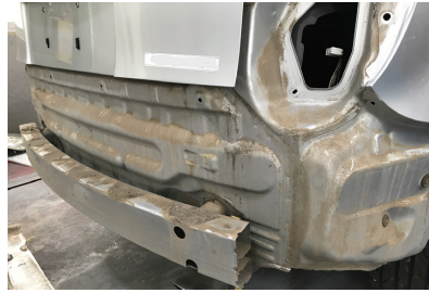
写真11 砂泥堆積状況
