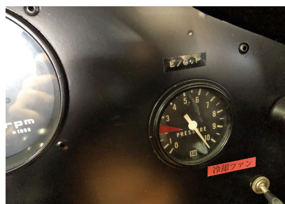
写真12 作動不良状態の油圧計
