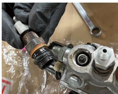
写真26 燃料ポンプOリングと銅ワッシャ交換(オーリング)
