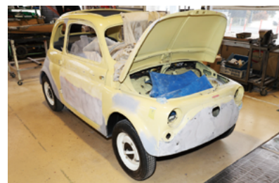
写真20 板金補修完成3
