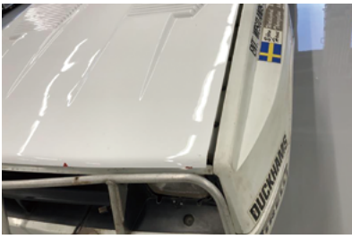
写真8 FRPボンネット塗装前
