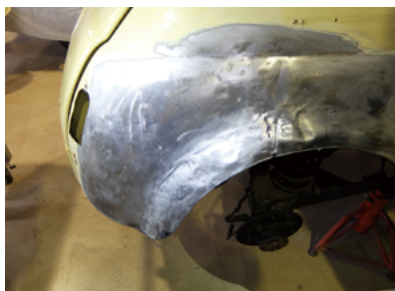
写真10 塗装剥離後の様子
