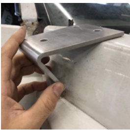
写真22 TGR-E 手配のウィングランプブラケットを実車に合わせて修正加工、取り付け
