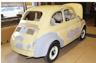
写真18 板金補修完成1
