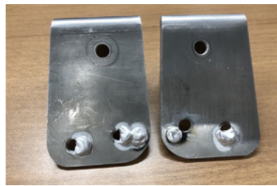
写真22 TGR-E 手配のウィングランプブラケットを実車に合わせて修正加工、取り付け
