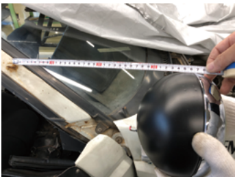
写真23 遊休補修パーツを流用加工して補助アームを取り付け
