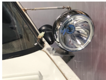
写真23 遊休補修パーツを流用加工して補助アームを取り付け
