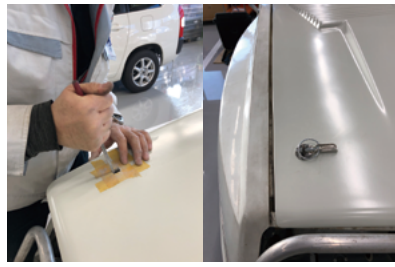
写真9 塗装後ボンネットピン取り付け
