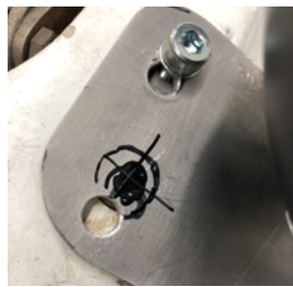
写真22 TGR-E 手配のウィングランプブラケットを実車に合わせて修正加工、取り付け
