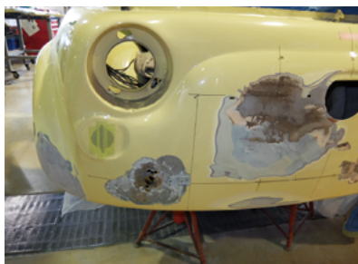
写真7 フロントグリル亀裂部
