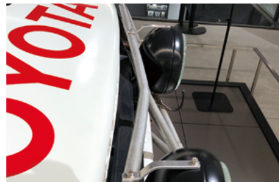
写真24 スポットランプ補助ブラケットを現物合わせで製作
