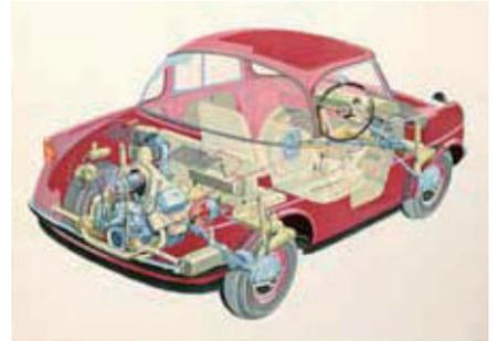
③リアエンジンであることが容易に見て取れる。ブレーキはアルフィン社製ドラム式(油圧内部拡張式4輪制動)。サスペンションはフロント、リアともにトレーリングアーム方式の全輪独立懸架。
