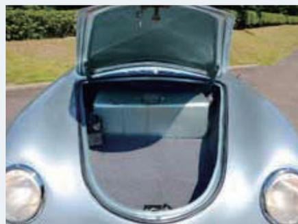
356では、フロントフード奥に燃料タンクが設置された。給油のためには、フードを開ける必要がある。
