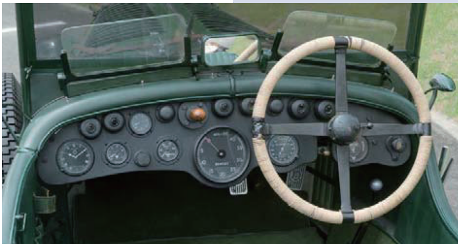
質実剛健なダッシュボード。ペダル配置は左からクラッチ、ブレーキ、アクセル。ギアボックスは前進4速。ダッシュボード中央の大きなメーターはタコメーター。
