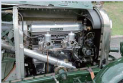
4気筒 SOHC 4バルブ 4398cc 110馬力
