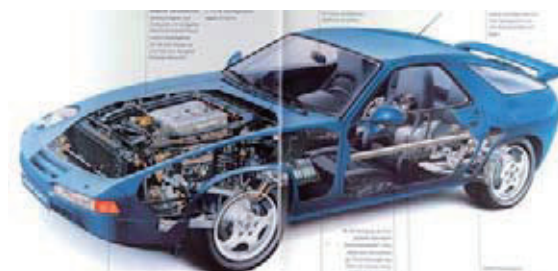
アルミ合金製V8DOHC32バルブ・エンジンとともに、ボデー同色化された巨大なリアスポイラーが見てとれる
