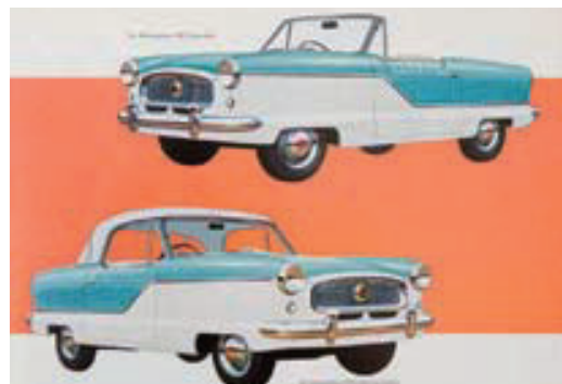
上1/4ほどをカバーするフエンダーによって前輪の切れ角が制限され、小さな車体の割には小回りが利かず、最小回転半径は5.3mあった
