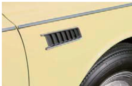
エアアウトレット エンジンルームの熱気抜きのために左右のフェンダーに設けられた
