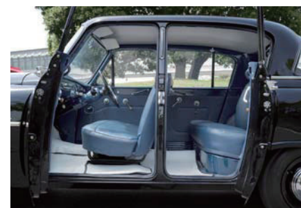
初代クラウンの特徴のひとつとなった観音開きドア。前後席とも3人掛けベンチシート。シートもドアの内張りもビニール。
