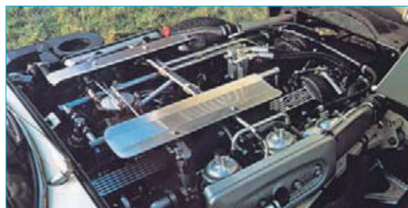
シリーズ3 V型12気筒のエンジンベイ。スペースの制約によってヘッドはSOHC
