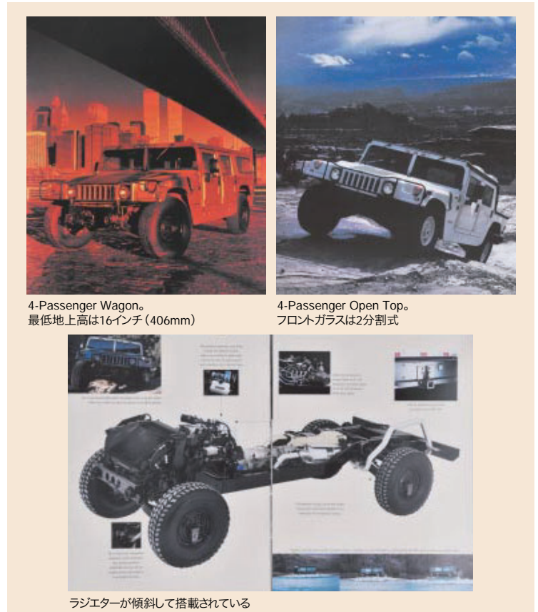
ラジエターが傾斜して搭載されている
