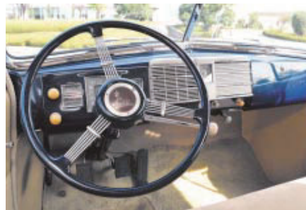
ギアシフトレバーをフロアからステアリングコラムに移動した最初のモデル
