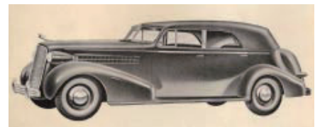
1936年型キャデラック60 4ドアコンバーチブルセタン サッシタイプドアガラス、前ヒンジ後ろ開きドア、4ドア4ライト、後ろに張り出したトランクなどが60Sに取り込まれた。
