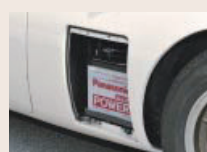
サービスリッド 右側前輪後方のサービスリッドにはバッテリーが納まる。左側にはエアクリーナー
