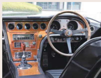
室内 美しいローズウッドのインパネ。ステアリングはマホガニー製。右から250km/hまで刻まれた速度計、9000rpmまでの回転計、電流計、水温計、油温計、油圧計、燃料計が並ぶ。ステッキ式のパーキングブレーキが古風
