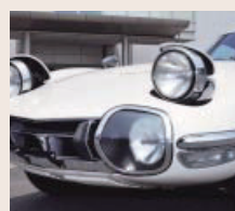
リトラクタブルヘッドランプ 国産車初のリトラクタブルヘッドランプを採用
