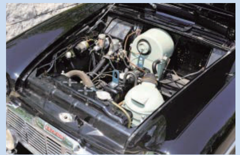
エンジン 水冷4気筒988cc、34馬力のエンジン。「超ショート・ストロークエンジン」と呼ばれ、高速時に優秀な性能を示したという
