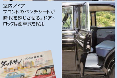
室内/ドア フロントのベンチシートが時代を感じさせる。ドア・ロックは歯車式を採用
