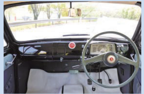
運転席廻り シンプルな計器類。トランスミッションは前進4段、後退1段のコラムシフト
