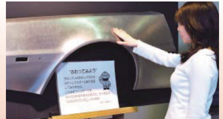
デロリアンのボディパネルはステンレス製で塗装されていない。(DMC-Japan協力)
