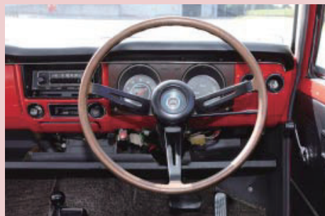
スプリンターには、3本スポークで木目を模したリムのステアリングホイールが採用されてスポーティさをさらに強調。
