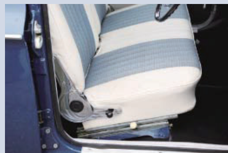
輸出対策の一環として、長身者のヘッドクリアランスを確保するため、14度の傾斜がついたスライドレール
