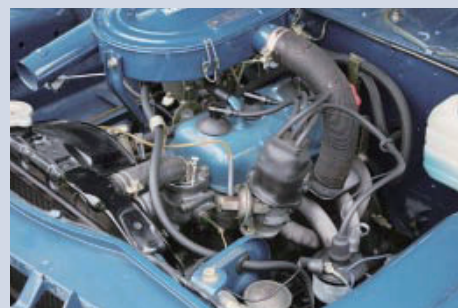
アルミ合金を多用したファミリアのエンジン。「白いエンジン」はエンジンブロックのアルミ鑄肌由来する(写真では補器類に隠れて一部しか見えない)
