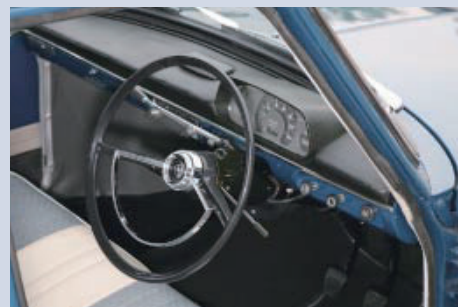
ダッシュボード上面には黒いレザーが張られている。ステアリング左側に見えるレバーはコラムシフト。右側に見えるレバーは、ウィンカーレバー兼ヘッドランプのハイ/ロービーム切り替えレバー
