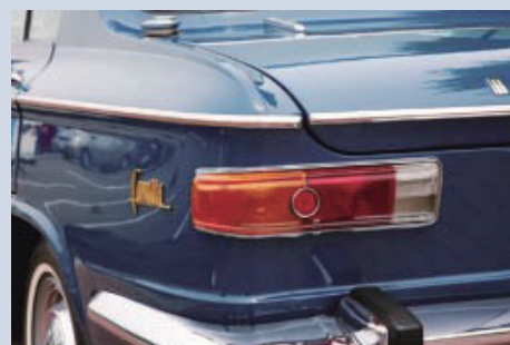
テールランプは、ウィンカー(黄)、ストップランプ(赤)、バックランプ(白)の「コンビネーション・ランプ」を採用
