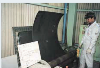
ガス発生炉の製作は厚手の鋼板を曲げることから始まる
