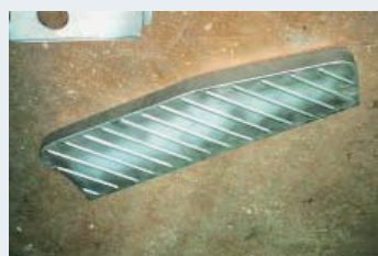
運転台乗降のためのステップパネルも手作り板金製作
