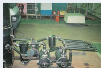
ガス発生装置を車両に装着する前、ベンチにて性能テストを実施
