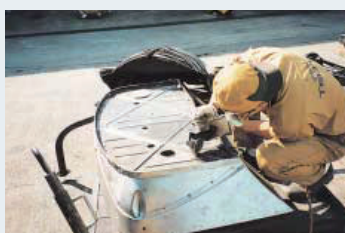
ダッシュボードも腐蝕部分は切り張り板金成形を実施
