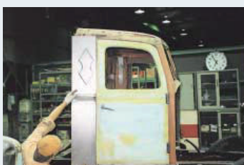
外板の模様プレス部分も鋼板から現物合わせて板金成形製作
