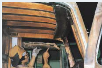
運転台天井の梁木材は使用可能であったため、ニス仕上げによる補修実施
