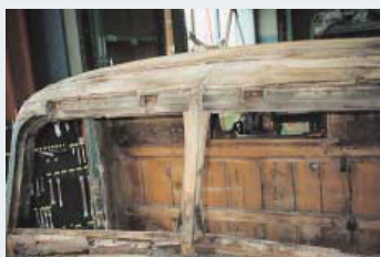
ボデーパネルの鉄板を剥がすと中は完全な木骨構造
