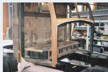
運転台の窓枠や柱などの木骨は新たに手作りで製作
