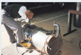
製作経験のあるベテラン職人によるガス釜製作の溶接作業
