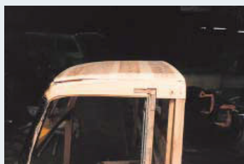
運転台の屋根板は腐蝕がひどいため、新たに杉の木板で張り替え
