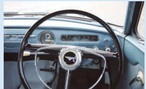
運転席回り 従来の丸型から横長に変更したスピードメーター。夜間、速度が45～50キロを超えると指針が赤色に変わり、警告を与えた
