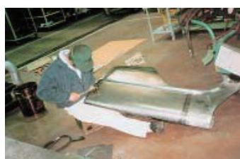
切断部分を鋼板から現物合わせて板金製作して張り合わせる
