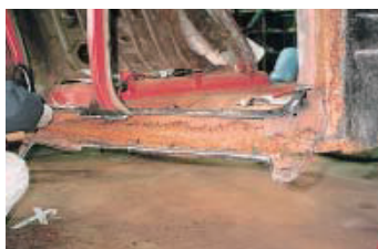
ボディ下部のロッカーパネル、腐蝕がひどい箇所を切り取る
