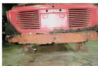
エンジンルームのロアバックパネルも腐蝕がひどい
