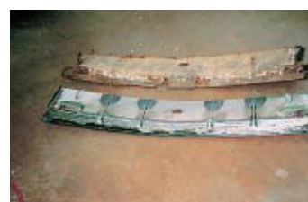
腐蝕したパネルを現物合わせて板金製作する
