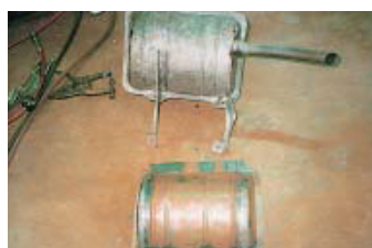
排気マフラーも腐蝕がひどいため、現物合わせて手造り製作
