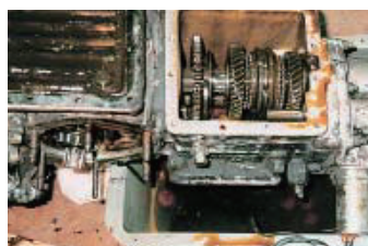
クラッチ、トランスミッションを分解整備
