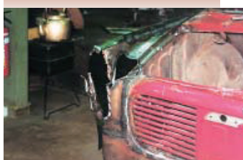
リヤーフェンダーの腐蝕がひどい穴あき部分は切断する
