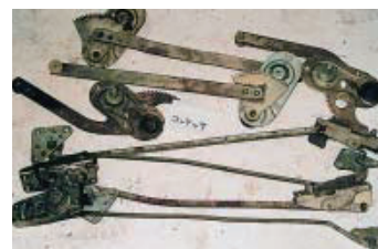
ドア内部のウインドレギュレーター等の部品も分解整備
