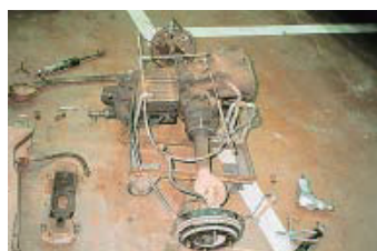
トランスアクスルも車両から降ろし分解整備を行う
