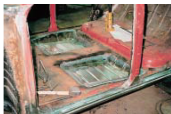
車内の床部も腐蝕がひどい箇所は切断し板金成形したパネルを溶接
