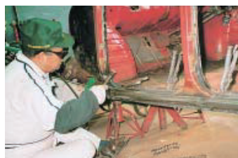
切断した部分はここのように鋼板から板金成形し溶接する
