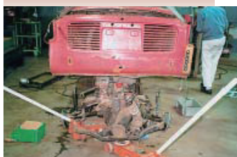
エンジンを車両から降ろし分解整備を実施
