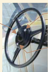
「スロットル」 左回しすると、エン ジン回転が下 がる。右回しする と、エンジンの回 転が上がる。
