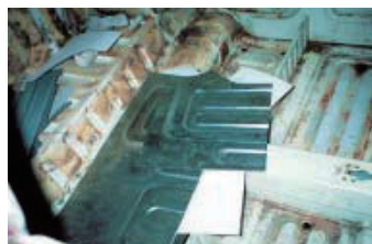
車内床面の腐食部分 現物合わせにて製作
