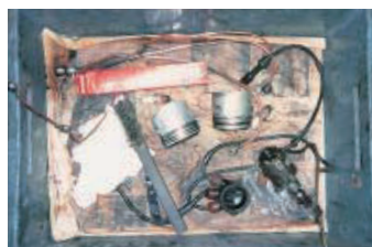
ピストン異常なし デストリビューターも分解
