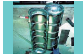
現物合わせにより二分割で板金製作して 溶接仕上げ
