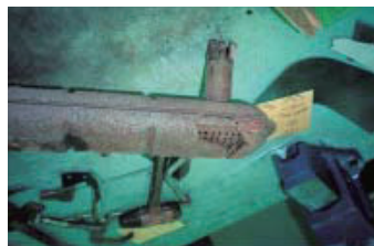
排気マフラー 腐食してボロボロ、穴あき
