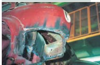
フロントフェンダー 腐食部分を切断
