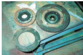
クラッチ部品も分解 ライニングは新規張り替え
