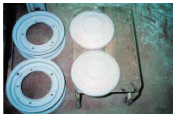
錆落し後、穴あき部分をパテ補修して 樹脂メッキ仕上げ
