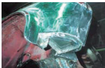
切断箇所を現物合わせて鋼板から 板金成形して溶接
