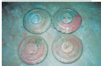
ホイールキャップ 腐食して穴があいている
