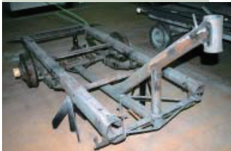
荷台等のボデーを外しシャシーフレームに分解
