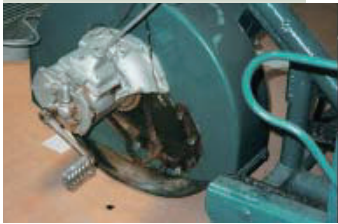
40年以上エンジン不動の状態 エンジンとトランスミッションを分解整備
