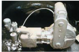
エンジンを降ろし分解 点火マグネットは磁力が低下していた為、着磁 処置
