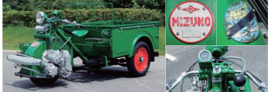
レストア完成後 (全長2750mm 全幅1170mm 全高1310mm 軸距離1700mm)
