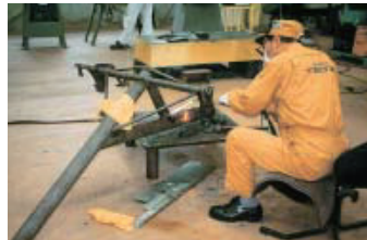
車台フレームは数箇所亀裂発生、溶接修理
