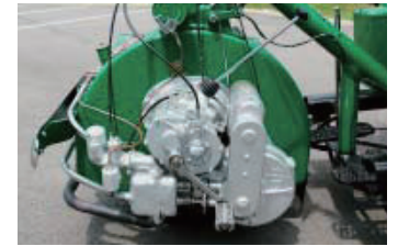
分解整備後 エンジンを組み付けた状態
