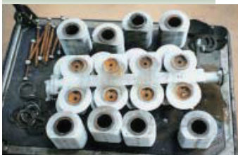
提灯型ラジエーター分解整備 冷却フィン部も手直し修理
