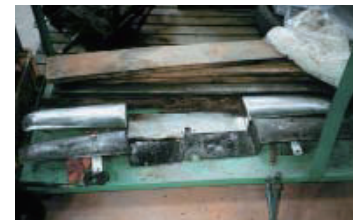
リヤバンパーも腐食が酷く現物合わせで板金 成形
