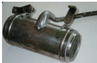
ホーンのラップ部品はデコボコ変形していたの を成形修正
