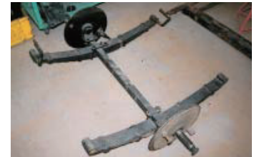
リヤサスペンション分解整備
