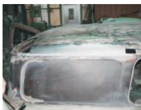
銅板から成形したパーツを溶接
