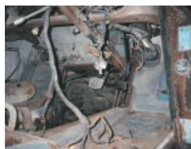
室内でも腐食部分が多い全ての部品を取り外す
