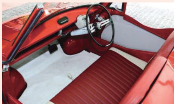
室内 最小限の操作部、計器類。シート下のレバーは前・後進切替用。 補強のためドア開口下部(ロッカー部) 高くし補強がされているのが見える。
