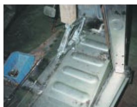
成形した部品を切断した個所に溶接貼り付け
