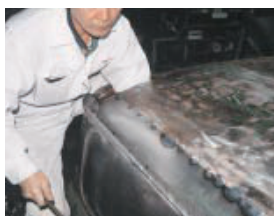
溶接貼り継ぎした部分を調整
