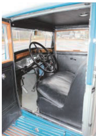
運転室。天井灯の周囲の通気孔からも排気する
