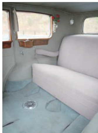
後部座席。適度の硬さで沈み込みが深い。長距離や悪路でも疲れにくかったと思われる。床通気孔には暖気取り入れ用の切り替え弁がある
