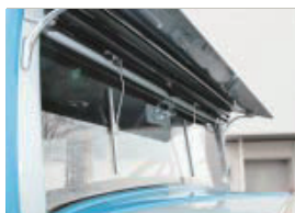
2本のゴムブレードが負圧で横方向に移動するワイパー
