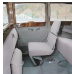
折り畳みシートは後ろに引くと座席になる。伸ばしても後部に座った人は膝がつかない。仕切り壁には全面ガラスが収納されていてハンドルで開閉する
