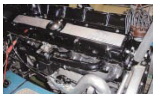
整然とした2バンクの16気筒エンジン
