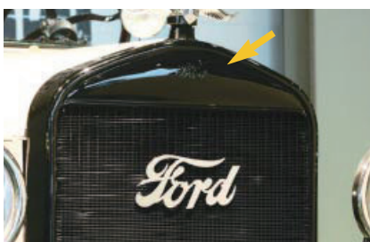
モデルT (1927) ラジエーターシェルにプレスされたFordの文字(矢印)は小さく目立たない。ラジエーター前面の大きな切抜き文字は本来この年式にはない。
