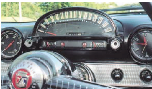
透明板を用い、スピードメーター背部から、景色が見えます。外光の反射による見づらさを、透過させて、逆利用したアイデア。
