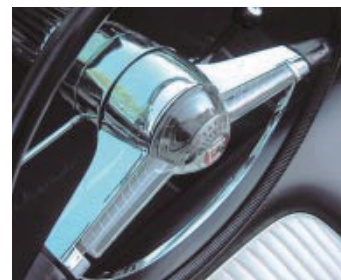
ステアリング・ハンドルのホーン部にも透明プラスチックは、大胆に使われています。クロムメッキとのコンビが新鮮です。
