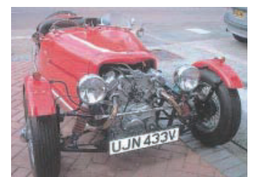
愛好者向けに少量生産された組立用キットカーの一例(イギリス)。ホンダCX500(日本ではGL500)のV型エンジンを搭載。
