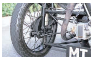
1909年の1号車から今も作られているモデルまで使われているスライディングピラー式のフロントサスペンション。
