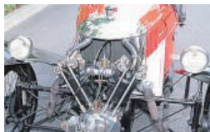
モーガンの特徴はむきだしのV型2気筒エンジン。空冷と水冷があった。写真のエアロは水冷でラジエーターはエンジンの背後。
