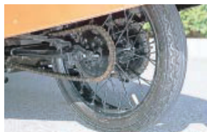
後輪の左右両側に歯数の異なるスプロケットがあり、前進2速はどちらにエンジンの回転を伝えるかを切りかえるだけ。左がハイで右がロー。一般的な3速ギアボックスは1931年から採用。
