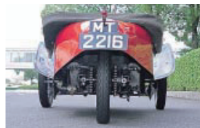
パンクは前輪が踏んで起こした釘を後輪が踏んで発生するケースが多いが、モーガンスリーホイーラーは前輪の後ろに後輪がないためパンクの頻度が少ない。
