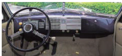
60スペシャル計器板全体 計器板全体がモダンなスタイルとなり、コラムシフトにより操作性も向上
