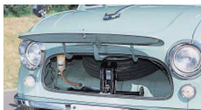
フロントパネル (展示車) フロントグリルを模したパネルを開けてスベアタイヤとジャッキを出し入れする。スベアタイヤの上部にガソリタンクがあり、ボンネットマスコットはガソリン注入口のキャップを兼ねる。
