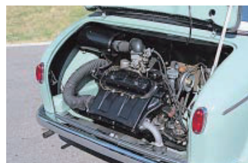
エンジンルーム (展示車) 空冷4サイクル2気筒エンジンは当初500ccだったが1961年8月から600ccに変更されて出力は20%アップした。
