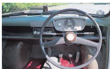
ダッシュボード（展示車） メーターの右横に横H式のギアシフトパターンが示されている。
