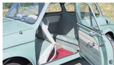
後席（展示車） 当初2人掛けで背もたれを倒して荷物スペースにもできたが、1961年8月から3人掛けとし背もたれは固定式となった。
