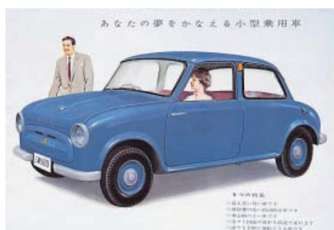
三菱500 1960(昭和35)年4月(カタログより) 実用性と低価格を優先したことから外観は非常にシンプル。サイドターンシグナルランプはセンターピラー上部に付けることで前後を省略。大径タイヤは穴のある道を考慮して地上高(22cm!)を確保したもの。 1960(昭和35)年4月時点での国道の舗装率はわずか28.8%だった。
