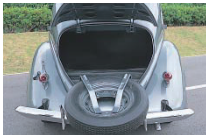
トランク内に格納されたスペアタイヤはブラケットで出し入れが容易
