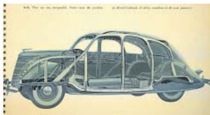
時代を先取りしたモノコック構造を採用
