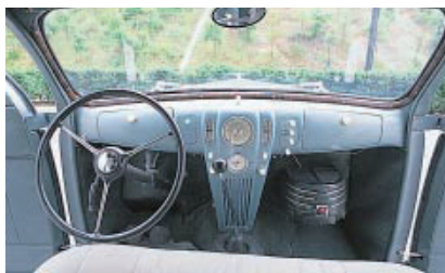
斬新な飛行機型計器盤にはセンターメーターを採用
