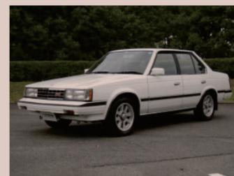
1982年1月に発売の7代目にして最後の後輪駆動のコロナ。この車両は1.8リットルDOHCターボ付ユニットを搭載。
